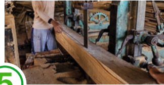
Holz wird grob vorgesägt und sortiert
